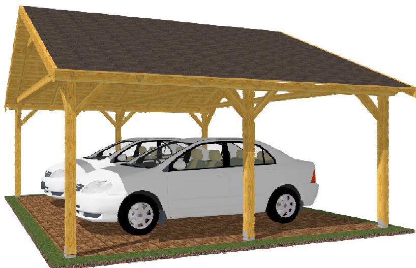
Střešní krytina: asfaltová šindel
